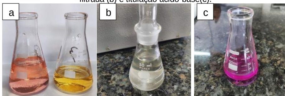
Figura 25 - Frascos do ensaio de Chappelle modificado com padronização do ácido (a), solução filtrada (b) e titulação ácido-base(c).
