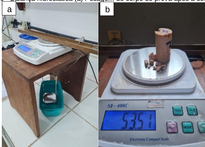
Figura 26 - Balança hidrostática (a) Pesagem de corpo de prova após a secagem (b)
