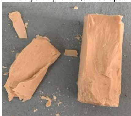
Figura 24 - Corpo de prova 4,5G750 após a fratura
